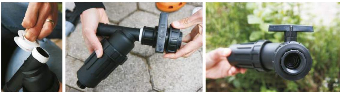
Nasprotni navoj filternega kosa prav tako obvijemo s teflonskim trakom, nanj pa privijemo koleno z notranjim navojem. Sestavljena pipa mora izgledati tako, kot prikazuje spodnja srednja slika, zadnja slika pa prikazuje položaj pipe, ko je privita na sod.
